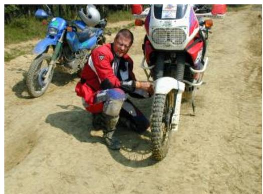
war und das Schutzblech vorne auf dem Reifen schleifte. Irgendwas wirklich heftig dickes musste hinten von unten zwischen Schutzblech und Vorderrad geraten sein. Die Befestigungslöcher waren ausgerissen. Naja, Schrauben los, alles wieder einfädeln und ordentlich anziehen, weiter geht's. ;-)
